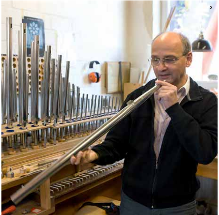
Der gute Ton: Pfeifenmacher Alfons Solleder verleiht den Pfeifen den richtigen Klang (1). Auf der Intonierlade können ganze Pfeifenregister feingestimmt werden (2). Die Register werden über verborgene Seilzüge in der Orgel bedient (3).
