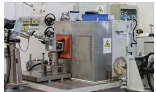
Simulierte Fahrt: Etwa ein Dutzend hydraulische Prüfstände messen das Verhalten von neuen Fahrwerksteilen unter verschiedenen Bedingungen.
