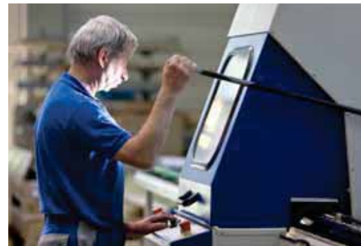
Genauer Zuschnitt: Johann Roth passt Linearteile an der Trennschleifmaschine nach Kundenwunsch an.
