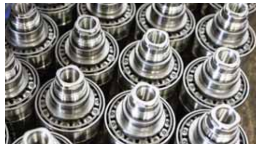
Lager für Lager: Für die ROPA Landmaschinen liefert Ludwig Meister mehr als 215 verschiedene Wälzlager (unten). Einige davon werden von Hand in die Reinigungswalzen des Rodeaaggregats eingebaut (oben).
