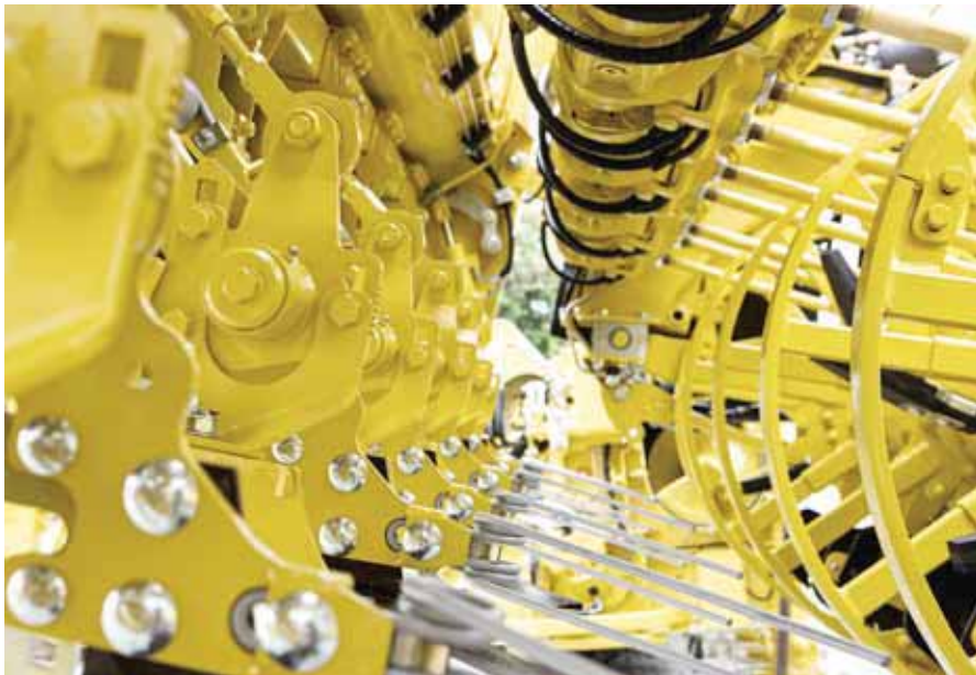
Vielteilige Präzision: Mit dem Rodeaaggregat werden die Rüben entblättert, beschnitten und aus dem Boden gehoben – bis zu neun Reihen gleichzeitig.
